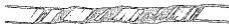
Fig. 30-12. Fotografía de un pequeño cristal de cobre después de estirado. [Cortesía de S. S. Brenner, Científico Principal, Centro de Investigaciones de la United States Steel, Monroeville, Pa.]
